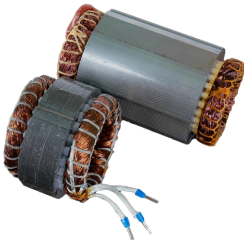
Vergleich der Statorabmessungen der "Sowelmasch"-Kappsäge und des Stators eines Motors mit Standardwicklungen
