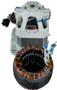
Vergleich der Statoren von Rasenmähern: "Sowelmasch"-Asynchronmotor (im Vordergrund), dahinter – der Kollektormotor des Rasenmähers
